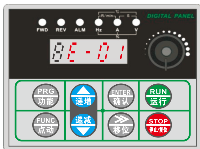
图1-5 加速中过流故障报警显示
