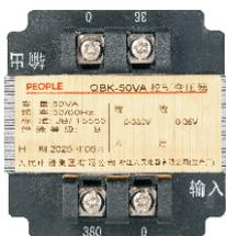
QBK系列控制变压器(以下简称变压器)主要应用在起重机控制系统中,是起重机控制柜的配套专用产品,它将单相或两相50Hz/60Hz频率的交流额定电源电压转换成控制系统中控制电器所需要的单相交流电压,为控制柜中的控制电器提供电源。
