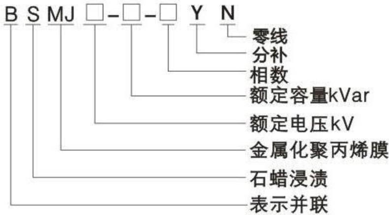
注: BSMJ(Y)为电力电容器圆柱型
