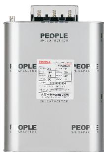
分相补偿并联电容器，采用目前先进的锌铝复合金属化膜，引用国内外先进的生产工艺，技术及先进设备，对于三相不平衡负载，可使用分相补偿电容器，对A、B、C三相中的任何一相单独进行投切、分相补偿无功功率。这样使补偿精度更高，节电效果更佳。
