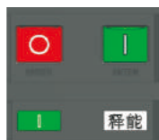
断路器合闸且无储能状态
