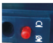
在位置锁锁定后，需要继续操作摇柄时，按下位置锁按钮，解除锁定(解锁状态)
